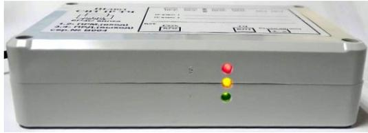
Шлюзы СВТ ІР-ТЧ служат для создания каналов ТЧ по ІР сетям. Шлюз может служить ТЧ окончанием в системах конференц связи, как Клиент в режиме точка-точка (direct ІР).
